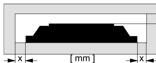
Bild: Mindestabstände beim Trafo-Einbau
